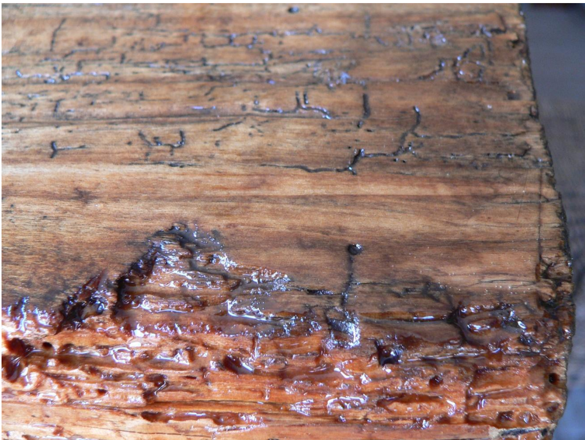
A műgyanta jól beivódott a porózus részekbe
